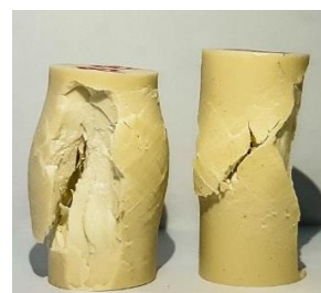
Gambar 5. Foto pecahan spesimen uji tekan komposit curing temperatur 27°C selama 24 jam, post-curing 90°C 5 jam penambahan HGM 17%.
