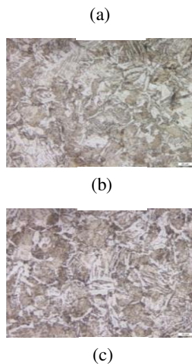
Gambar 12. Struktur mikro baja hasil perlakuan panas perbesaran 1000x dengan variasi temperatur partitioning 325°C dengan variasi waktu penahanan partitioning (a) 10 detik, (b) 100 detik, dan (c) 1000 detik
