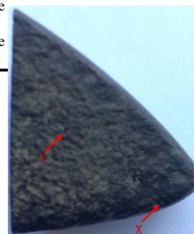
**Gambar 4** Pengamatan makro komponen *Crossbar* gagal (*crack*)
