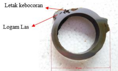
Gambar 8. Potongan tube yang mengalami kegagalan
