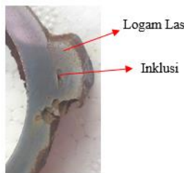
Gambar 9. Inklusi pada logam las
