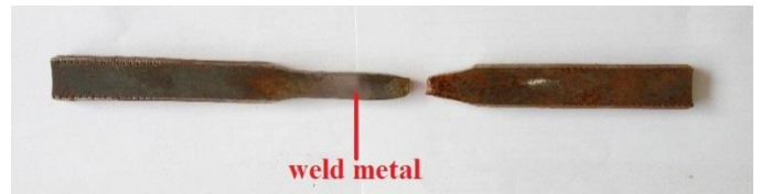
Gambar 4. Hasil Pengujian Tarik
