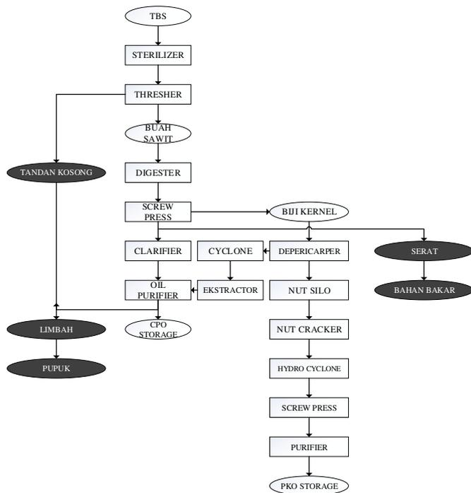
Gambar 1. Skema Proses pembuatan CPO dan PKO
