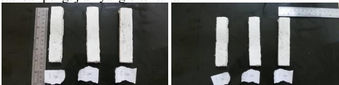
Gambar. 5. Spesimen uji kuat lentur yang telah dilepaskan dari cetakan
