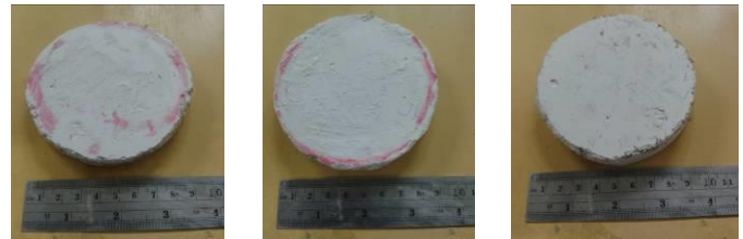
Gambar. 7. Spesimen uji absorpsi suara, terlihat ada bagian yang tidak rata
