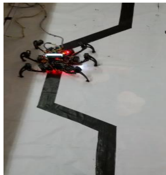
Gambar 18. Robot ketika berjalan mengikuti garis hitam
