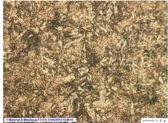
Gambar 3. Temper martensit perbesaran 1000 didekat patahan
