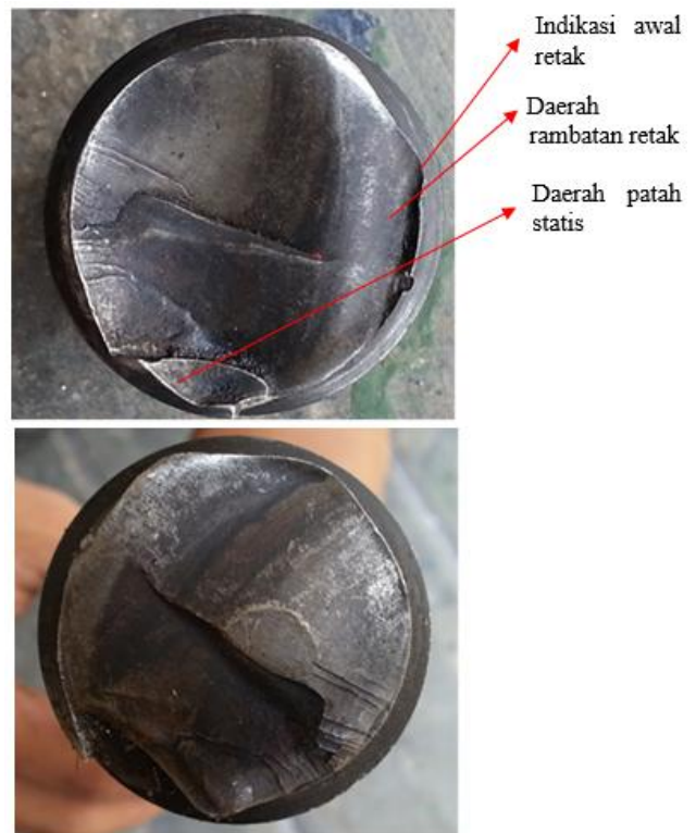
Gambar 1. Permukaan patahan baut
