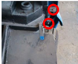
Gambar 12. Peletakan lubang untuk sambungan baut
