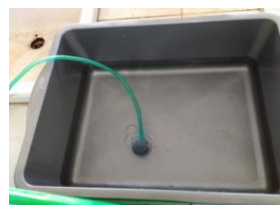
Gambar 1. Tahap pengozonan di dalam air selama 5 menit, 10 menit, 15 menit dan 20 menit
