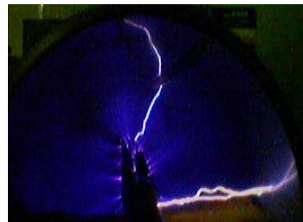
Gambar 2. Lucutan arc pada sistem elektroda kawat-silinder [9]
