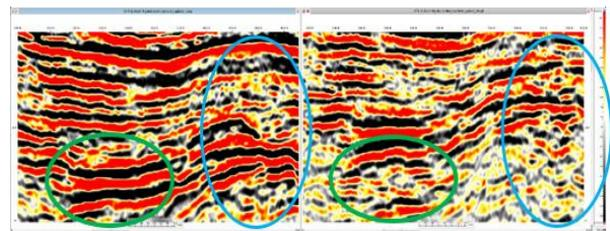
Gambar 4.4 Perbandingan kemenerusan reflektor antara (a) PSDM dan (b) PSTM, *reef build up* ditunjukkan oleh lingkaran berwarna biru dan ketidakmenerusan reflektor ditunjukkan oleh lingkaran berwarna hijau
