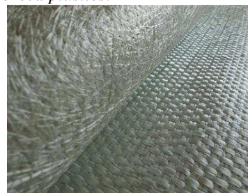
Gambar 6. Combo mat CTG E-Glass sebagai reinforcement skin.
