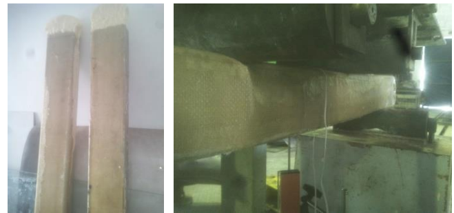
Gambar 17. Pembuatan benda uji (kiri) dan pengujian gravity load (kanan) balok sandwich.
