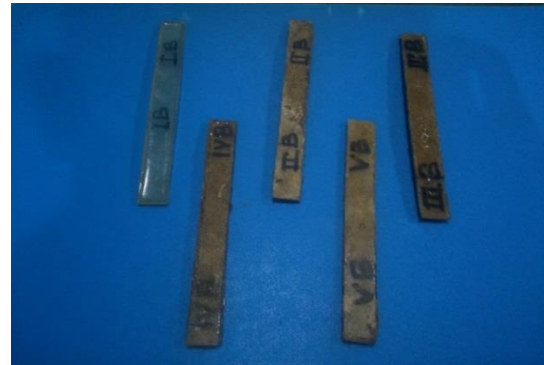
Gambar 2 Spesimen Uji Kelenturan
