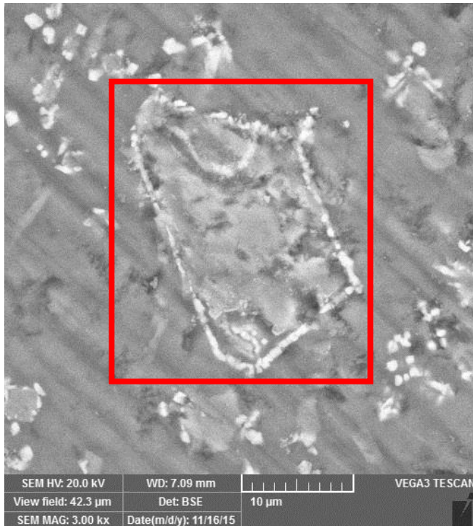
Gambar 11 Hasil SEM beton dengan tambahan mikrobakteri
