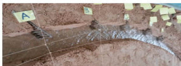
Gambar 12. Gambar Perbandingan Morfologi Sungai Dengan Surfer 8 Untuk Sudut Krib 90°
