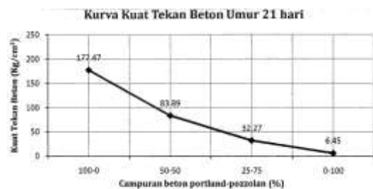
Gambar 4.5 Hubungan persentase penggunaan semen Pozzolan tipe-A terhadap kuat tekan beton pada umur 28 hari
