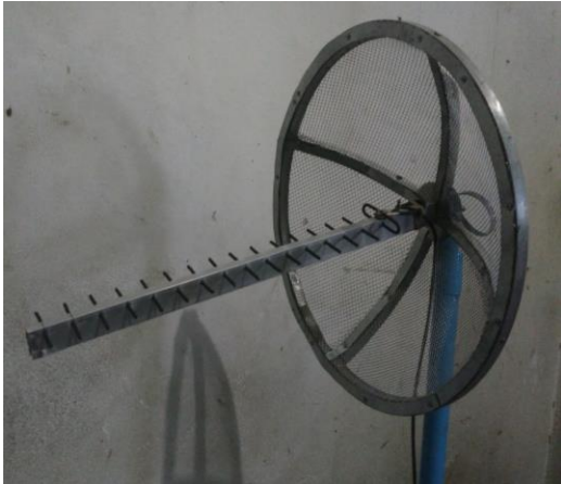
Gambar 6. Antena Yagi dengan Reflektor Bolik
