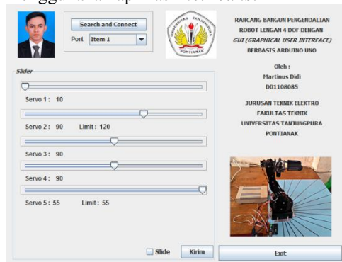
Gambar 3.16 Tampilan Interface Pengendali Robot Lengan 4 DOF.
