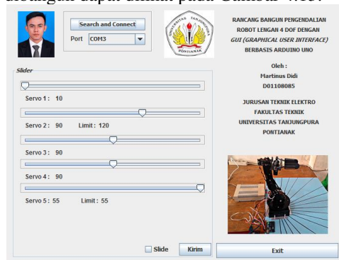
Gambar 4.13 Tampilan Interface Pengendali Robot Lengan 4 DOF.
