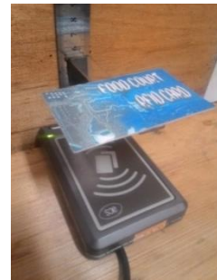
Gambar 26. Analisis jarak pembacaan reader
