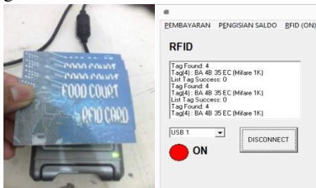
Gambar 27. Analisis kemampuan pembacaan RFID reader
