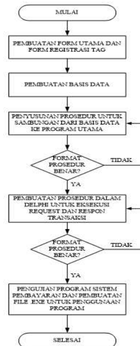
Gambar 8. Diagram alir perancangan perangkat lunak
