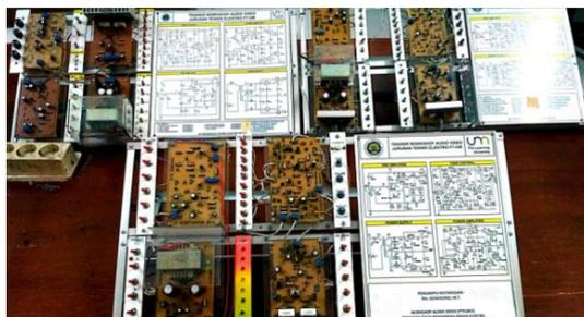
Gambar 3. Trainer Perawatan dan Perbaikan Sistem Audio
