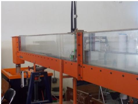
Gambar 5. *Flume* saluran terbuka
