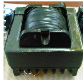
Gambar 17. Transformator Inti ferit setelah penggulangan.
