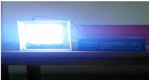
Gambar 22. Pengujian Durasi hidup lampu LED
