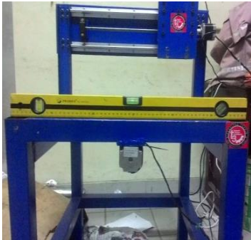
Gambar 10 Kerataan meja kerja di ukur menggunakan waterpass
