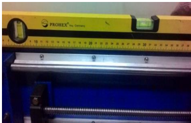
Gambar 11 Kelurusan plat Y diukur dengan menggunakan waterpass
