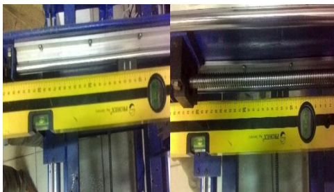
Gambar 12 Kelurusan rel Y1 dan Y2 diukur menggunakan waterpass
