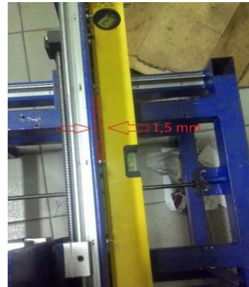
Gambar 13 Kelendutan plat Y di ukur dengan menggunakan waterpass
