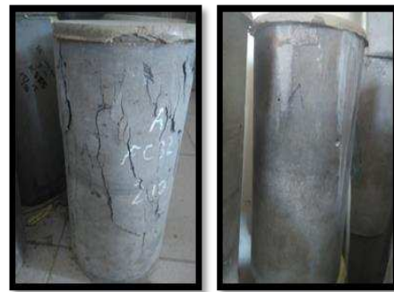
Gambar 6. Kondisi Retak Akibat Compression Pada Beton Kelompok 1
