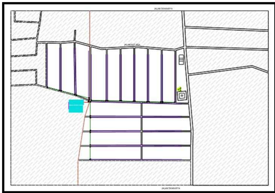
Gambar 3. Gambar Perletakan Manhole Sistem Penyaluran Air Limbah di Perumahan Mutiara Permai.
