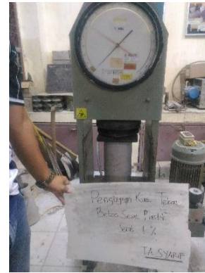
Gambar 3. Pengujian kuat tekan beton
