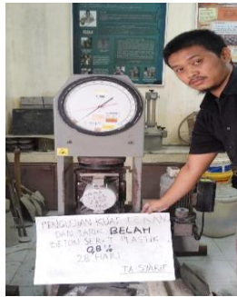
Gambar 4. Pengujian kuat tarik belah
