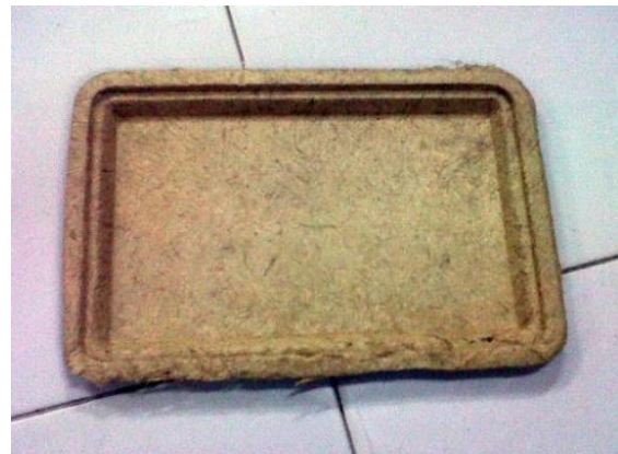
Gambar 3. Kemasan pulp cetak batang jagung tanpa perekat
