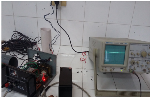
Gambar 12 Gelombang Catu daya utama berbeban 5 V
