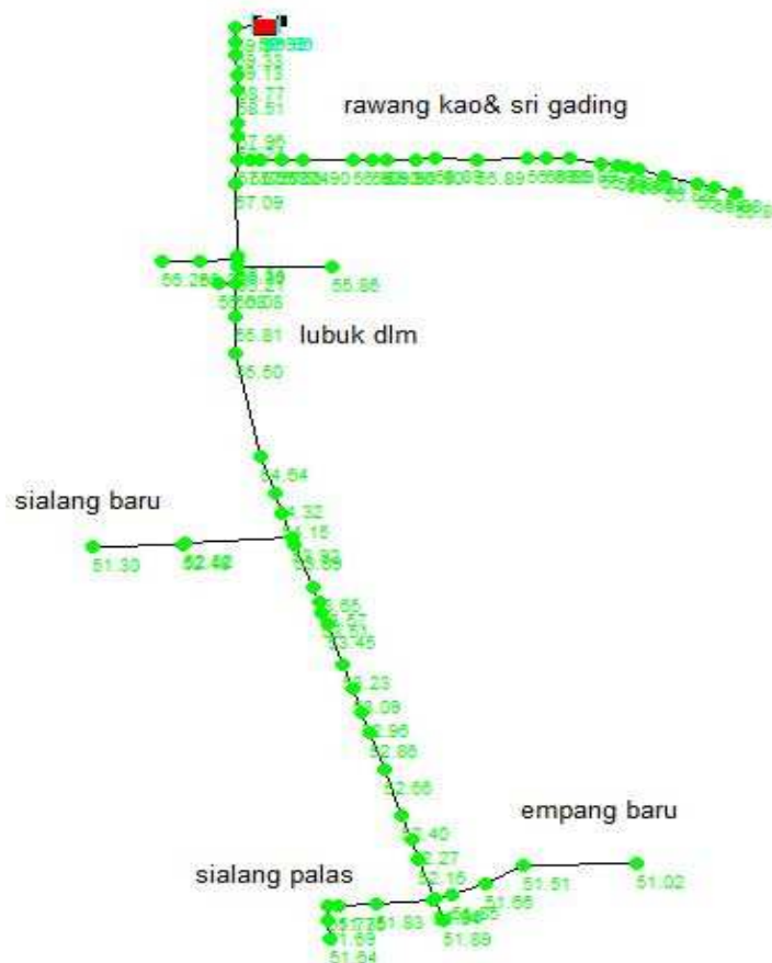
Gambar. 3: Jaringan pipa distribusi air bersih
