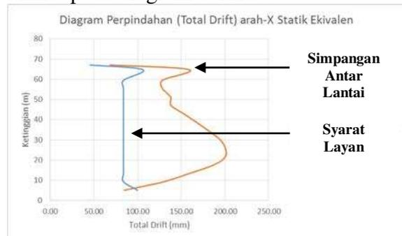
Gambar 3.3 Simpangan Antar Lantai Arah X Statik Ekuivalen
