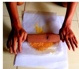
Gambar 3. Pembuatan Serbuk Resin Phenolic
