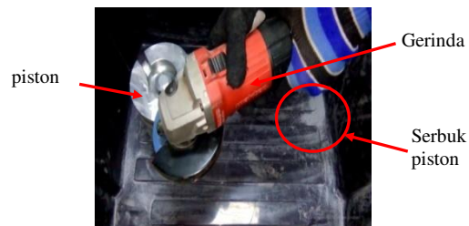
Gambar 2. Pembuatan Serbuk Piston 100 mesh
