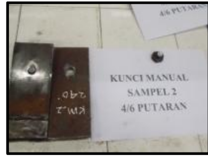
Gambar 8. Lubang baut berbentuk oval pada sampel yang menggunakan kunci manual ( turn of nut ) sampel dengan pretension 4/6 putaran
