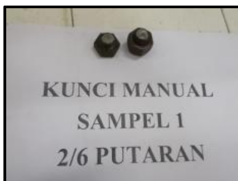
Gambar 7. Kegagalan geser baut yang menggunakan kunci manual ( turn of nut ) pada sampel 1 dengan pretension 2/6 putaran
