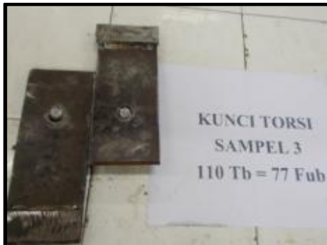
Gambar 6. Lubang baut berbentuk oval pada sampel yang menggunakan kunci torsi sampel dengan pretension 110 Tb
