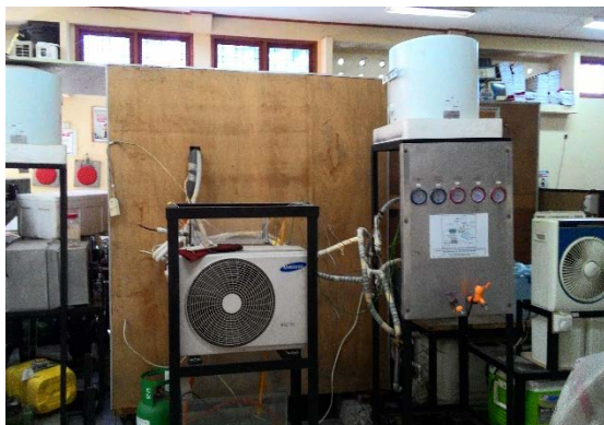
Gambar 2. Foto Alat Uji Mesin Pengkondisian Udara Hibrida
