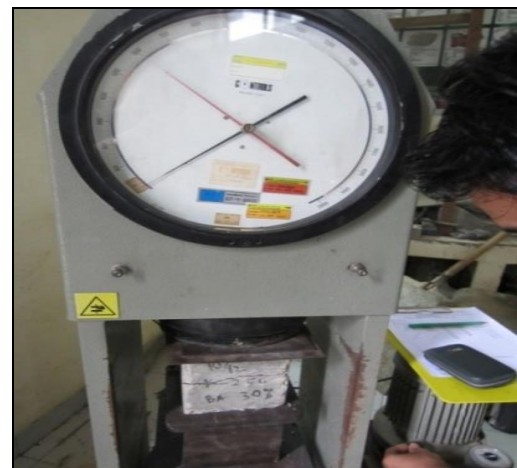
Gambar 2. Pengujian kuat tekan
