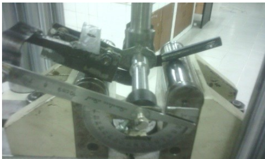
Gambar 9. Proses pembengkokan dengan metode three point bending .
