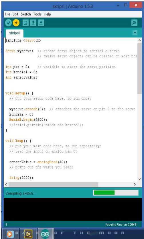
Gambar 4.1 Arduino menverifikasi program untuk memastikan tidak ada kesalahan penulisan program dan mengupload program ke mikrokontroler
