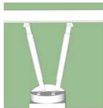
Gambar 19 Struktur Penyalur Beban Atap Sumber: Hasil Pengembangan Desain, 2014
