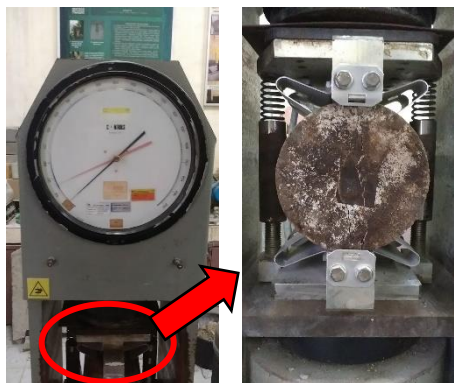
Gambar 3. Pengujian Kuat Tarik Belah
