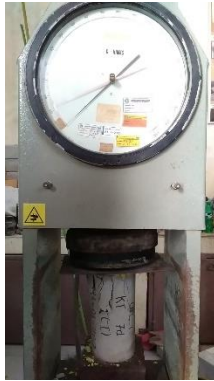
Gambar 2. Pengujian Kuat Tekan
