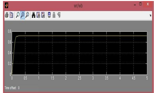
Gambar 4.11 Kecepatan motor induksi tiga fasa delapan kutub 70 Hz
