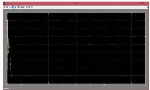
Gambar 4.7 Torka motor induksi tiga fasa delapan kutub 90 V
