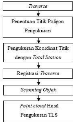
Gambar III-4 Diagram alir metode Traverse
