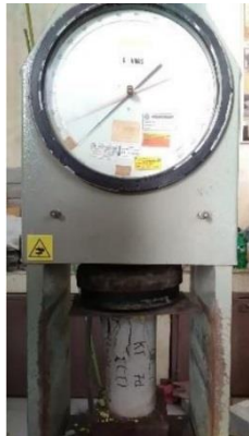
Gambar 2. Pengujian kuat tekan
