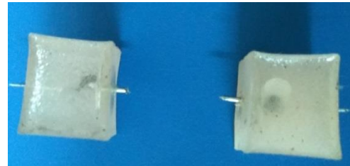
Gambar 4.1 Tembus listrik pada pengujian isolator resin murni dan resin + 0,2 gr (tampak dari kiri resin murni dan kanan resin + 0,2 gr alumina)
