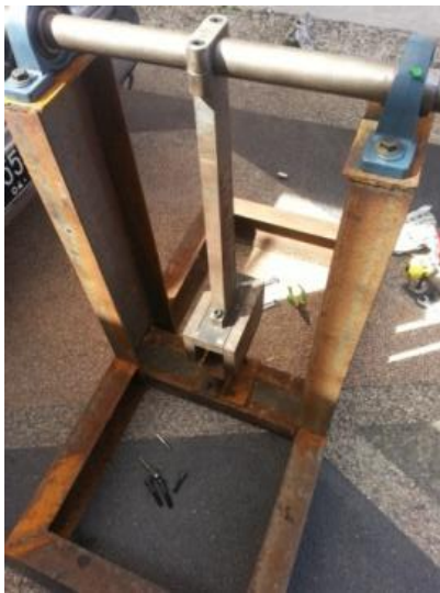
Gambar 10. Pendulum Alat Uji Impak Produk Las Gesek Bar-Plate
