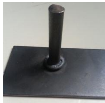
Gambar 3. Produk Bar-plate hasil pengelasan gesek
