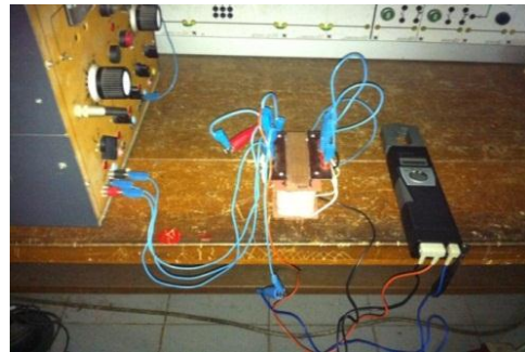
Gambar 4.18 Pengujian hubung singkat transformator tiga fasa
