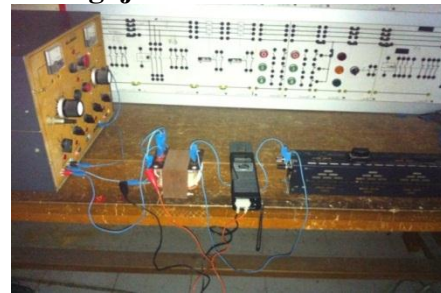
Gambar 4.14 Pengujian beban penuh transformator satu fasa
