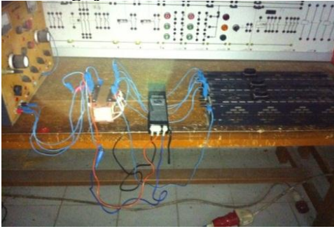
Gambar 4.19 Pengujian beban penuh transformator tiga fasa
