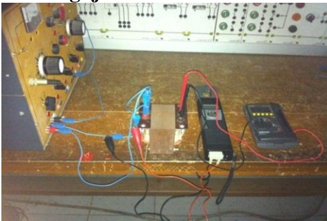
Gambar 4.12 Pengujian beban nol transformator satu fasa
