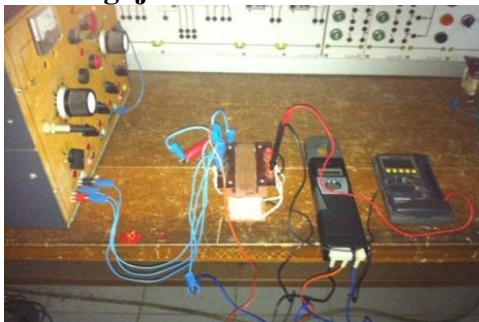
Gambar 4.17 Pengujian beban nol transformator tiga fasa
