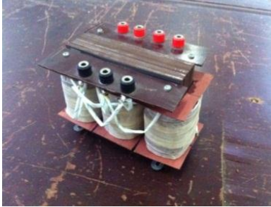
Gambar 4.11 Transformator tiga fasa
