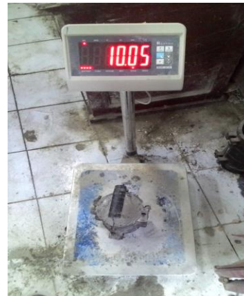
Gambar 1. Uji berat isi beton
