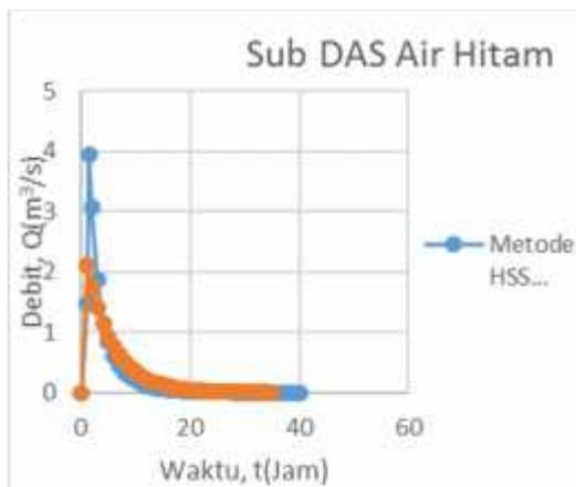
Gambar 10. Perbandingan Hidrograf metode HSS Gama I dengan Nakayasu pada sub DAS Air Hitam
