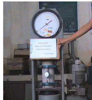
Gambar 1. Pengujian Kuat Tekan Dan Modulus Elastisitas
