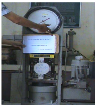
Gambar 2. Pengujian Kuat Tarik Belah
