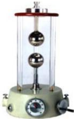
Gambar 3.3. Alat Pengujian Tegangan Tembus Isolasi Udara
