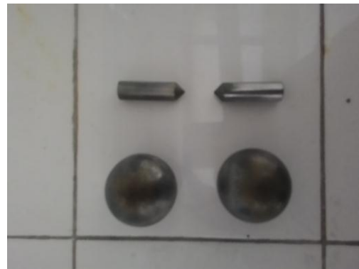
Gambar 3.4. Elektroda Bola-Bola dan Elektroda Jarum-Jarum
