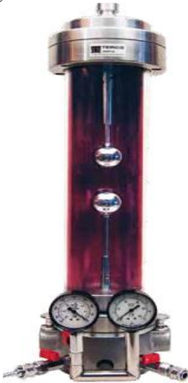
Gambar 3.2. Tabung Pengujian Tegangan Tembus Isolasi Vakum dan Udara Bertekanan
