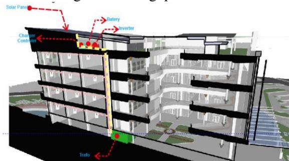
Gambar 2. Skematik Penempatan Solar Panel
